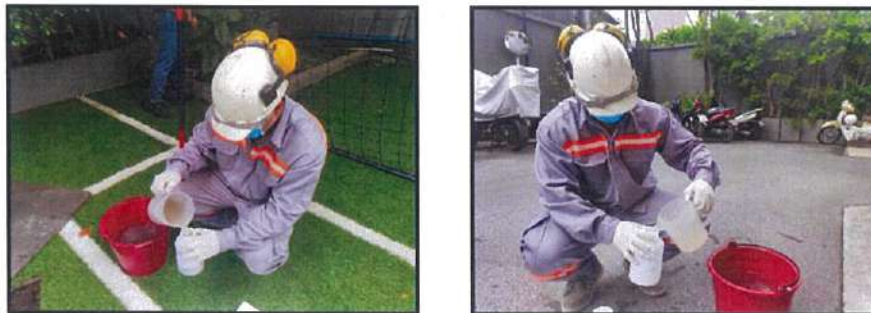
รูปที่ 4.4.1 การเก็บตัวอย่างน้ำทิ้งของโครงการ
